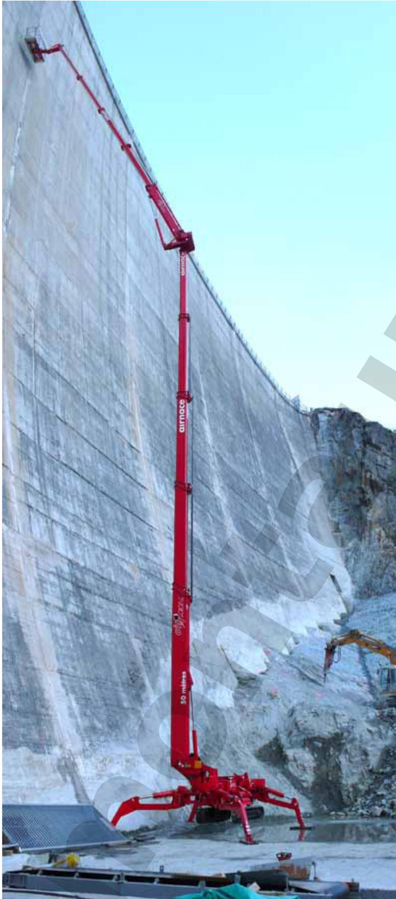
Charge max. du plateau d'appui 45 kN
